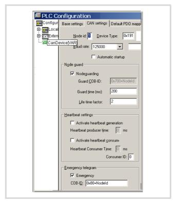
Figure 87: CAN device parameters
